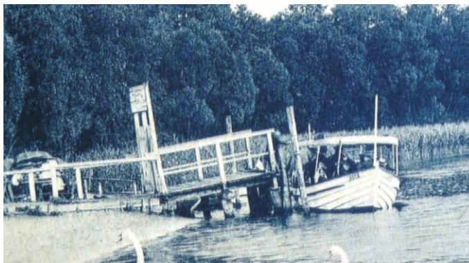
Dieses hölzerne, in Klinkerbauweise gebaute Motorboot POMMER, ein ehemaliges Rettungsboot, gehörte dem Badeanstaltbesitzer Pieper. Hier ist es bei Forsthaus Tegel zu sehen. (AK ,Ausschnitt, Tegelportal)
