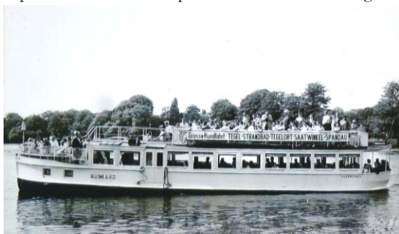
Die BADEN-BADEN nach dem ersten Umbau bei dem das Schiff eine erhöhte Back bekam. Foto Slg. Mette
