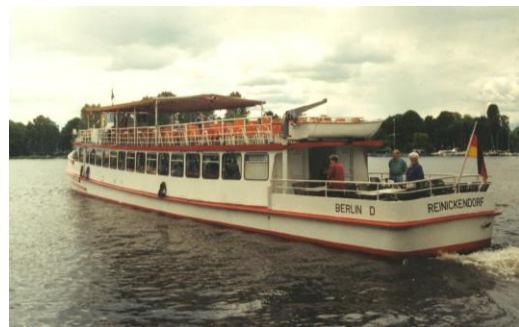
Dieses Schiff, das heute als REINICKENDORF im Dunstkreis der Reederei Bethke immer noch Fahrten auf dem Tegeler See anbietet, wurde als großer Schleppdampfer erbaut. Notdürftig mit Aufbauten versehen, wurde es nach dem Krieg als Fahrgastschiff RHEINGOLD eingesetzt. Zum Motorschiff wurde es dann bei der Reederei Haupt. Als SEEHAUPT kam es 1958 wieder in Fahrt. Bei einem weiteren Umbau bekam das inzwischen in REINICKENDORF umbenannte Schiff ein Kastenheck. Später wurde der moderne, schnittige Bug angebaut. Mit einem geraden Bug wie vorher würde das Schiff meines Erachtens vorteilhafter aussehen. (AK Slg. Bluhm)
